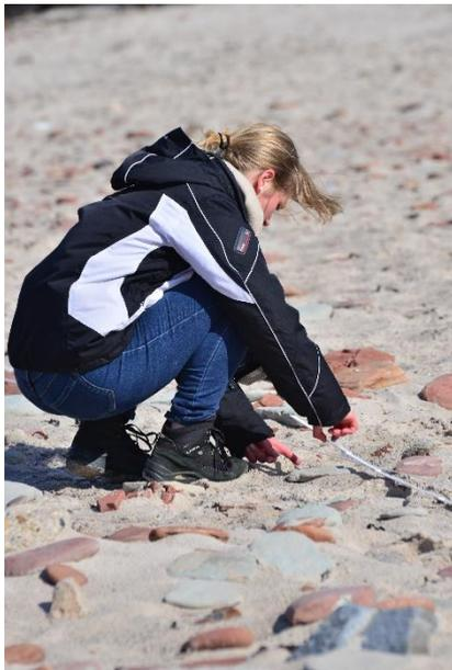
wird eine Leine bis zwischen die bei Ebbe trockengefallene Felsen gespannt. Dann wird abschnittsweise die Höhendifferenz bestimmt.
