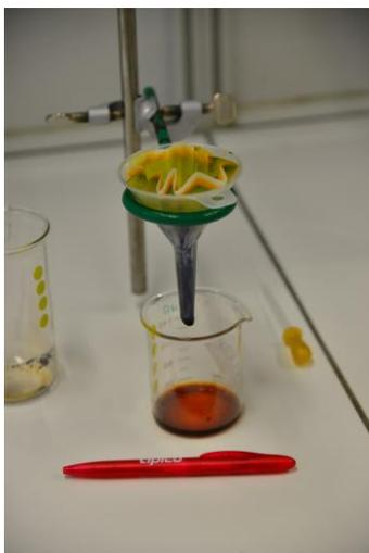
Die erste Indigosynthese gelang Adolf von Baeyer, zunächst aus Isatin, später aus o-Nitrobenzaldehyd. Auf dessen Spuren wandelten die Studierenden in einem ersten Versuch. Aus Nitrobenzaldehyd und Aceton entstand unter Einfluss von Natronlauge ein Niederschlag, der abfiltriert wurde. Zunächst entstehen Indoxylmoleküle, von denen sich jeweils zwei zum Indigomolekül verbinden.
