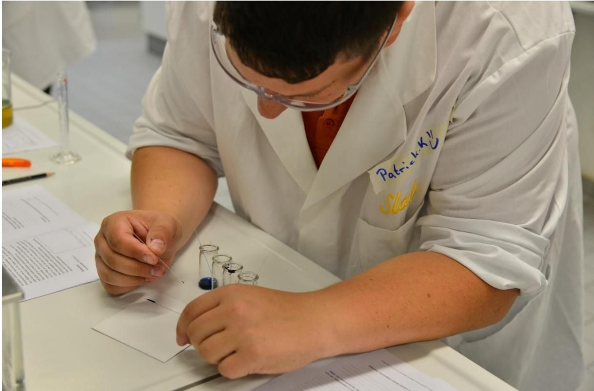
nimmt die Moleküle der aufgetragenen Substanzen mit. Da sie in der gleichen Zeitspanne abhängig von der Molekülgröße unterschiedlich weit transportiert werden, kann man im Vergleich mit Referenzwerten die Inhaltsstoffe der Proben bestimmen oder erkennen, ob eine Probe eine Mischung
